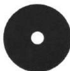
El disco de decapado más eficaz de 3M. Su construcción abierta le permite decapar sin embazarse con la suciedad. Se utiliza para la eliminación rápida de residuos de viejos acabados y selladores
